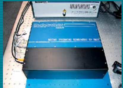
Die aus dem Institut heraus gegründete Firma MenloSystems stellt heute Frequenzkämme in der Größe eines Schuhkartons her.
