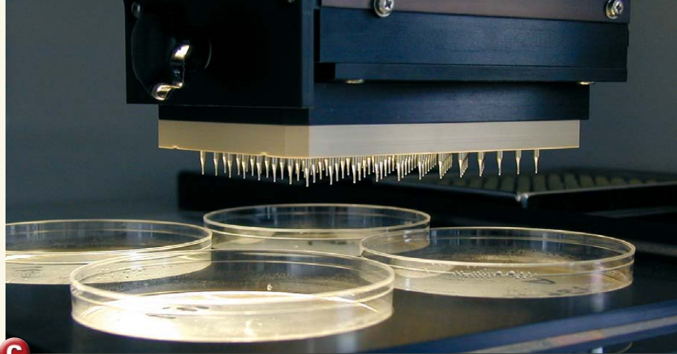
▲ Im Labor überträgt ein Roboter die Bakterienkolonien auf Mikrotiterplatten.
