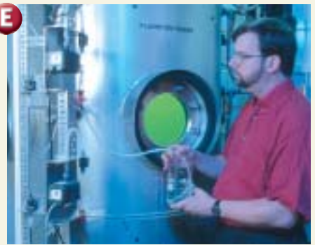
▲ Ein Wissenschaftler entnimmt eine Probe aus dem Planktonturm. Links sieht man die regelmäßig angeordneten Probenentnahmestellen, in der Mitte eines der Beobachtungsfenster.
