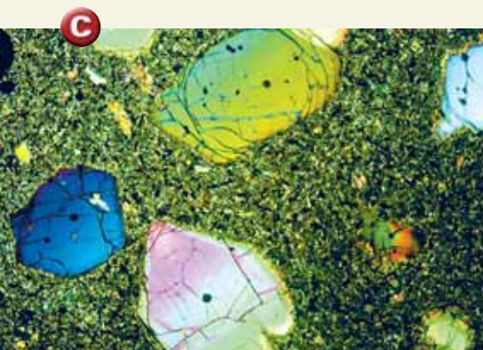
▲ Partes de las muestras obtenidas de núcleos de perforación se cortan en láminas, se las pega en una placa de vidrio y se las pule hasta alcanzar un espesor de unas pocas centésimas de milímetro. La mayoría de los minerales (en este caso basalto de Hawaii) se vuelven transparentes y pueden clasificarse bajo el microscopio.
