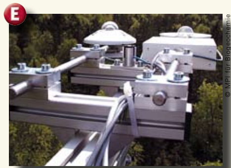
▲ Medidores de radiación en una torre micro meteorológica.
