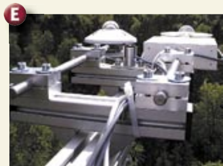
▲ Strahlungsmessgeräte an einem mikrometeorologischen Messturm.
