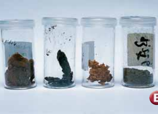
▲ Catalizadores compuestos de varios metales preciosos son menos susceptibles a la "intoxicación" por monóxido de carbono que los catalizadores de platino puro. Rutenio, osmio e iridio son testeados.
